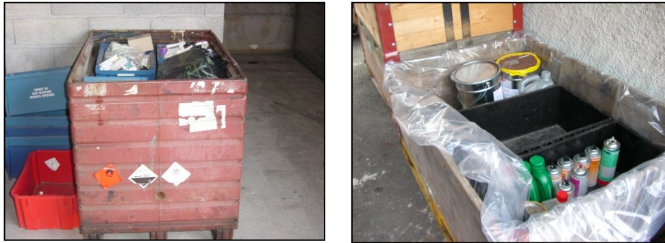
Abb. 9: Behälter mit doppelter Verpackung, der mit bis zu 300 kg Sonderabfall beladen werden kann.
