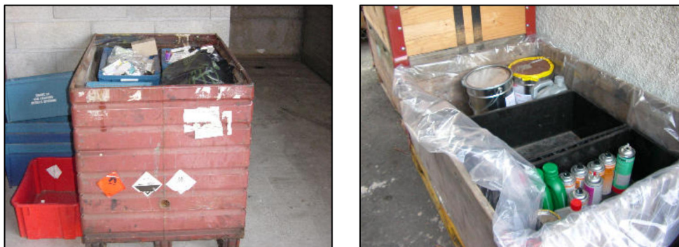
Fig. 9: Conteneur avec double conditionnement pouvant recevoir jusqu'à 300 kg de DSM
