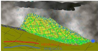
Dans un aquifère de perméabilité moyenne à faible, avec une zone saturée très développée (faible vulnérabilité), les eaux fraîchement infiltrées transitent très lentement au sein de l'aquifère : une légère augmentation du débit est observée au fil du temps à la source, tandis que la conductivité électrique et la température restent relativement constantes.
