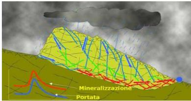
Dans un aquifère de faible perméabilité, avec une zone saturée étendue (vulnérabilité élevée à moyenne), les eaux fraîchement infiltrées contraignent les eaux souterraines emmagasinées vers l'exutoire, se traduisant par une augmentation de la conductivité électrique et de la température de l'eau à la source.
