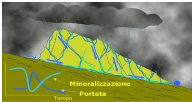
Dans un aquifère à forte perméabilité et sans zone saturée (vulnérabilité très élevée), les eaux fraîchement infiltrées arrivent rapidement à la source (forte diminution de la conductivité électrique et changements de température très prononcés).
