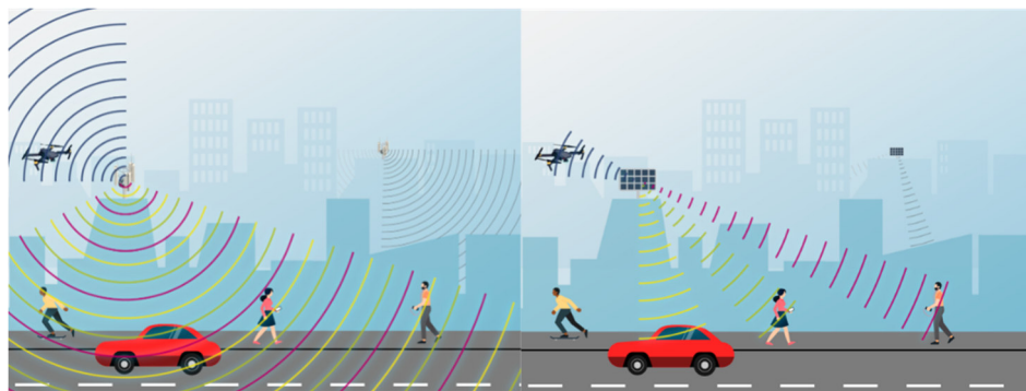
Abbildung 6: Konventionelle Antenne (links) et adaptative Antenne (rechts) (Quelle: BAKOM)
