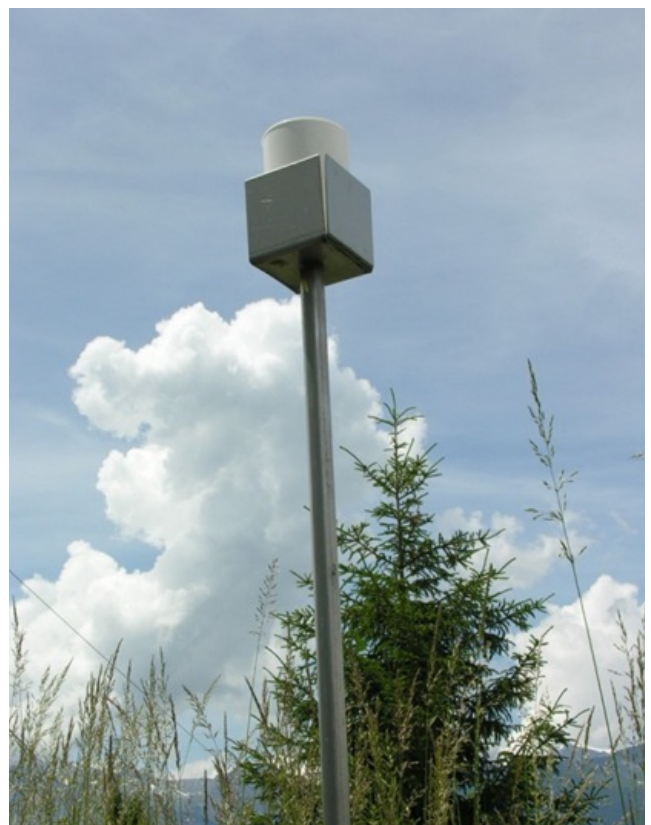
Bergerhoff-Gerät für die Staubniederschlagsmessung
