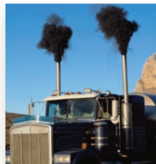
Figure 18: les gaz d'échappement non épurés des moteurs diesel sont des sources majeures de BC
