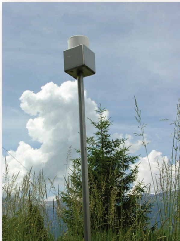
Figure 27 : Appareil de prélèvement Bergerhoff
