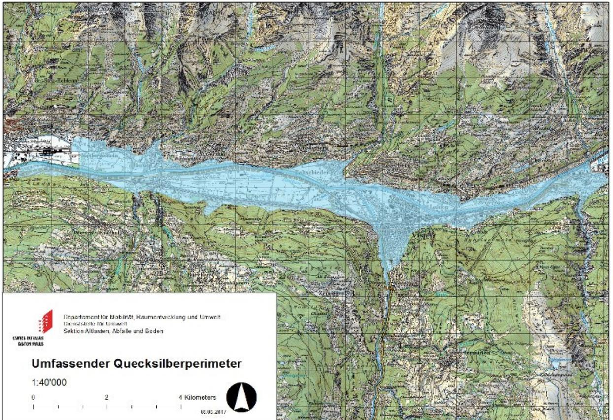
Im umfassenden Quecksilberperimeter kann eine Quecksilberbelastung des Bodens nicht ganz ausgeschlossen werden. In diesem Perimeter muss bei sämtlichen Bauvorhaben mittels Bodenuntersuchungen sichergestellt werden, dass kein mit Quecksilber belastetes Material in Umlauf gebracht wird. Dabei ist mit der DUW Kontakt aufzunehmen, um das Vorgehen zu besprechen. Die im Verdachtsperimeter liegenden Gemeinden sind auch über das Vorgehen informiert.
