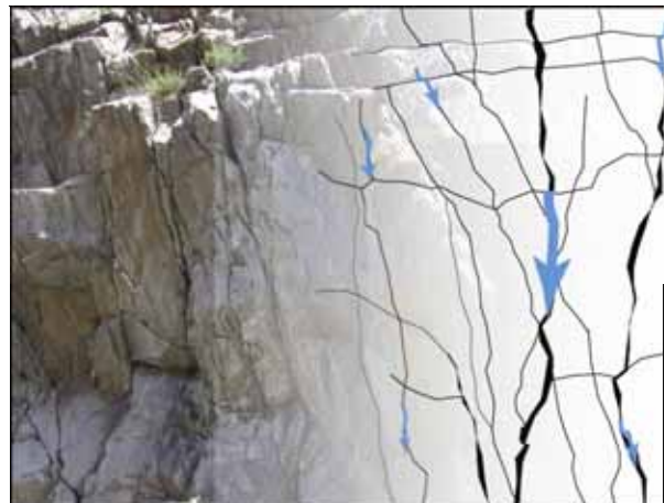
Abbildung 6d: Fließwege des Grundwassers im geklüfteten Gestein.
